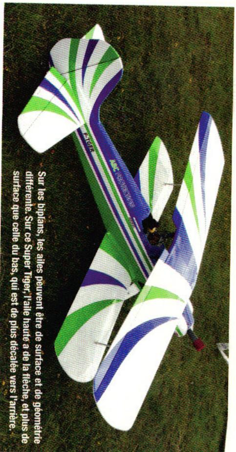
Sur les biplans, les ailes peuvent être de surface et de géométrie différente. Sur ce Super Tiger, l'aile haute a de la flèche, et plus de surface que celle du bas, qui est de plus décalée vers l'arrière.
