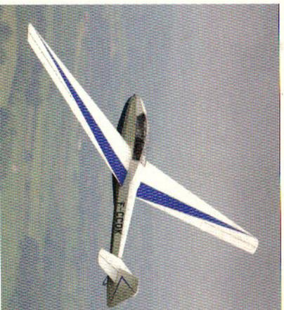
Cas typique d'aile en flèche inversée sur ce Bergfalke : le centrage reporté sur l'emplanture va être très proche du bord d'attaque, et c'est normal !
