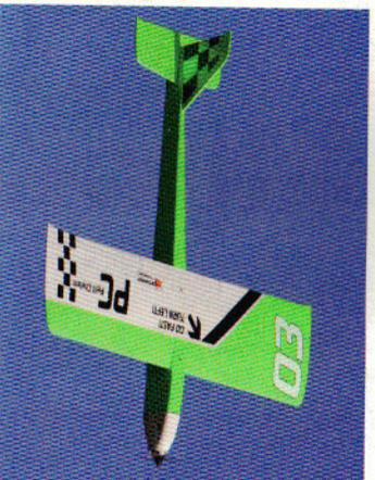
Les traceurs ont un tas de particularités : un volume de stab obtenu plus par le bras de levier que par la surface, un calage extrêmement faible adapté aux très hautes vitesses, et un centrage avant pour les rendre très stables aux plus hautes vitesses. Ça Petit Chalem de seulement 90 cm vole à 240 km/h et plus...
