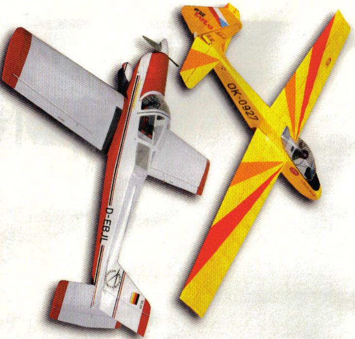
Selon les modèles, les ailerons peuvent être étroits ou très profonds. Le débattement doit être adapté en conséquence.
