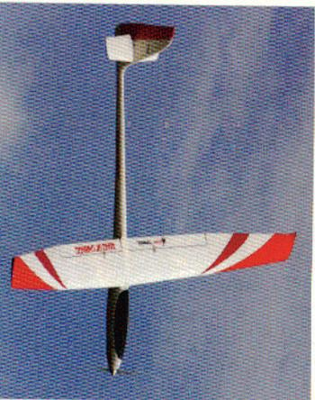
Les planeurs non maquette taillés pour la pefro volent avec un fuselage parfaitement à l'horizontale, pour une traînée minimale.
